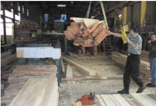
Les postes de réception des produits ne sont pas visibles des postes de conduite
