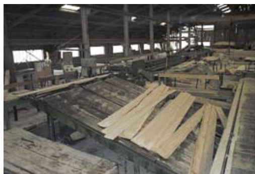
Accumulation des bois sur les chaînes de transfert
