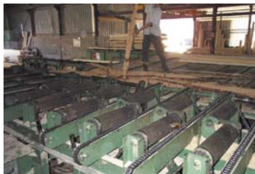
Intervention de l'opérateur chargé du tri sur un transfert pour démêler les bois
