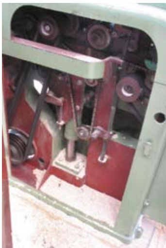
Absence de carter de protection et organes en mouvement accessibles
