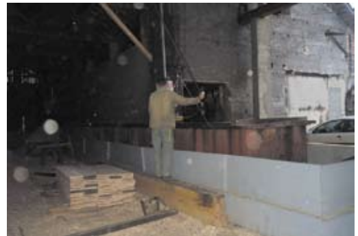
Trempage des bois dans la cuve à fongicide
