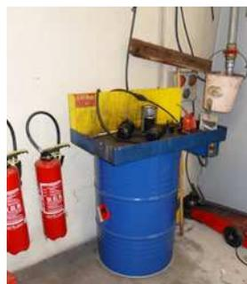
Photo 5 Poubelles ouvertes contenant des déchets de dégraissage, chiffons imbibés, ...
