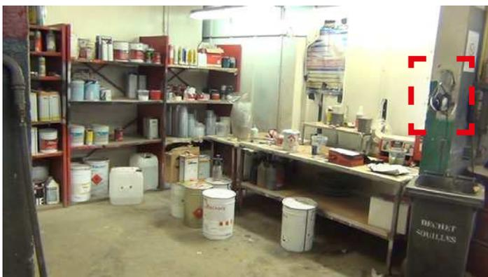
Photo 10 Chauffage sous une poubelle de déchets solvantés
