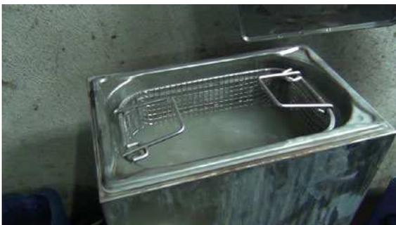
Photo 2 Fontaine lessivielle avec zones de nettoyage manuel et trempage
